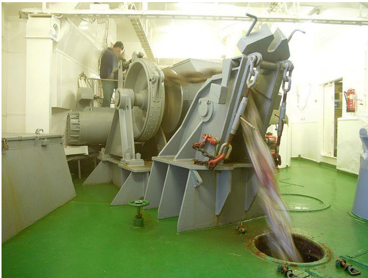
Figura 3 - Levantamento de âncora (navio de pesquisas alemã POLARSTERN) Fonte: https://commons.wikimedia.org/wiki/File:Polarstern_anchor-winch_hg.jpg
